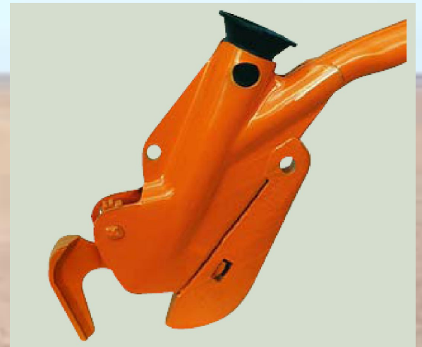
1-долотообразный сошник; 2-катор; 3-параллелограммный механизм
