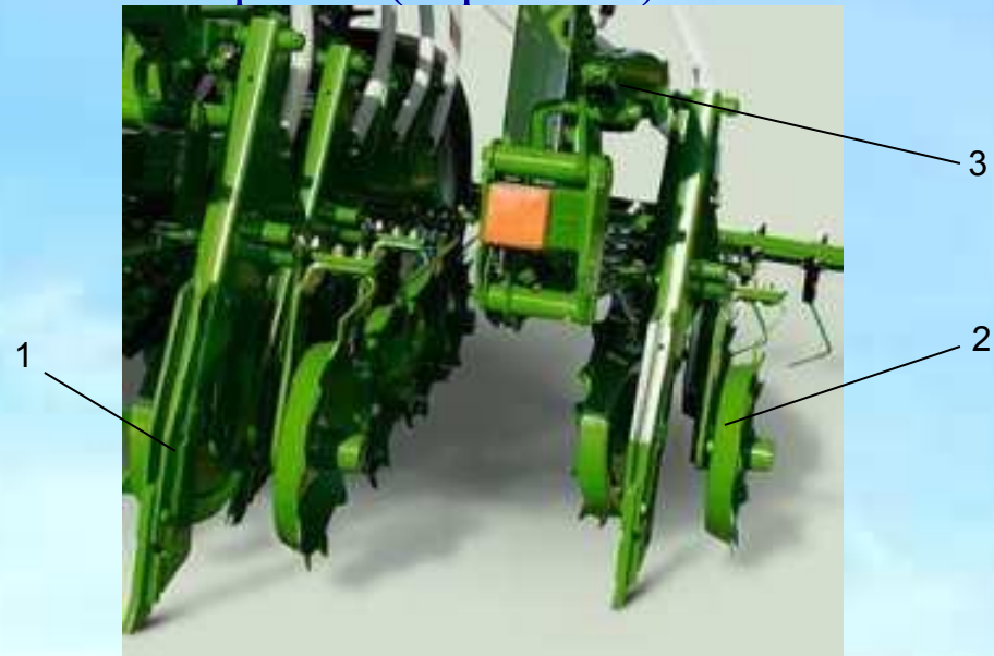
1-долотообразный сошник; 2-катор; 3-параллелограммный механизм
