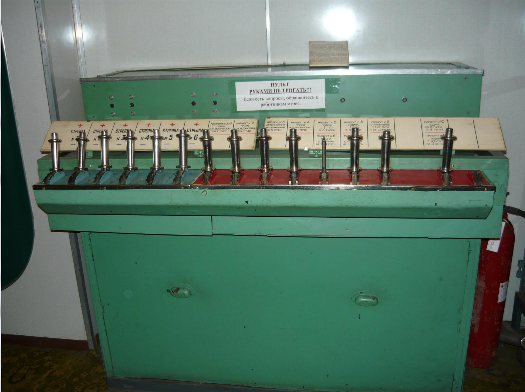
Диспетчерский пульт управления поездами(старый образец)
