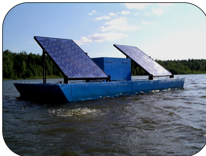
Плавучая аэрационная установка с питанием от солнечных фотоэлектрических батарей
