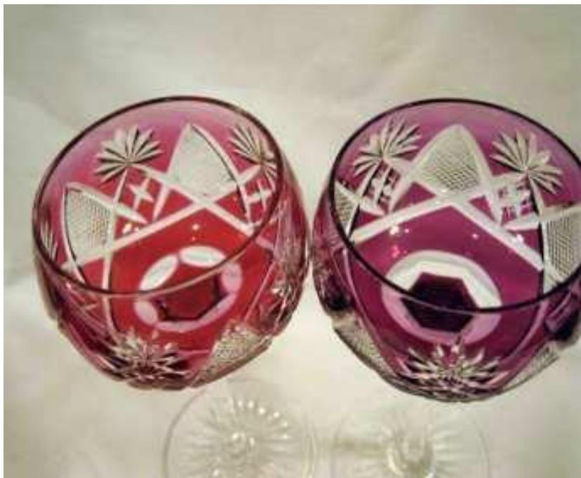
Изделия с нацветом (из накладного стекла) бывают с одним, реясе с двумя и более нацветами. Из цветного стекла выдувают «баночку» в виде двухстенной воронки, в нее вносят «баночку» из бесцветного стекла и раздувают ее до сплавления с цветной. Наружную стенку воронки смачивают водой и отбивают. Изделия соответствующим образом дорабатывают и декорируют алмазной гранью, гравировкой и др. Образуется бесцветный узор на цветном фоне.
