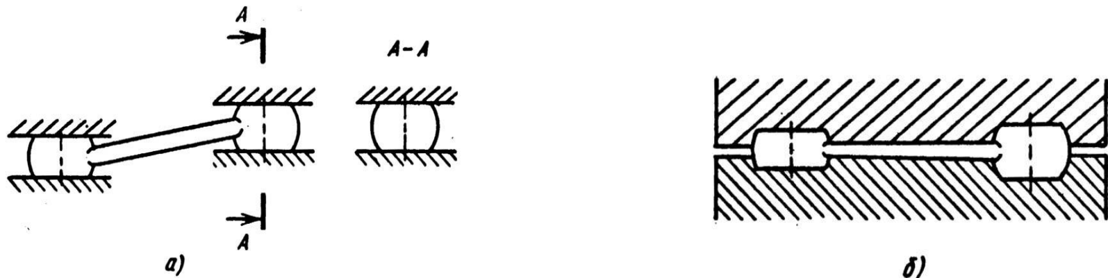
Рисунок 11.3 – Схема калибровки (а – плоскостная; б – объемная)
