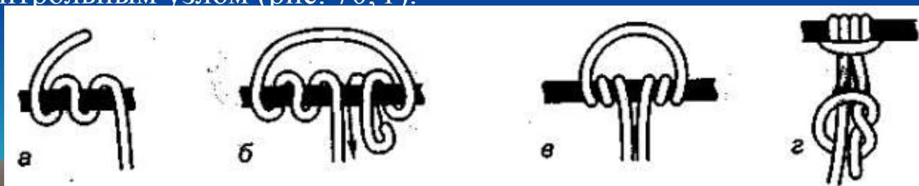
Рис. 70. «Схватывающий» узел одним концом
