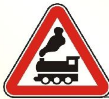
Железнодорожный переезд без шлагбаума
