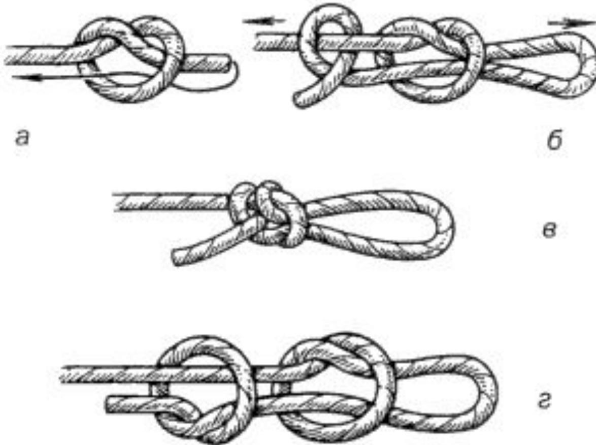
**Австрийский проводник, он же обратный проводник, он же ездочная петля,**
