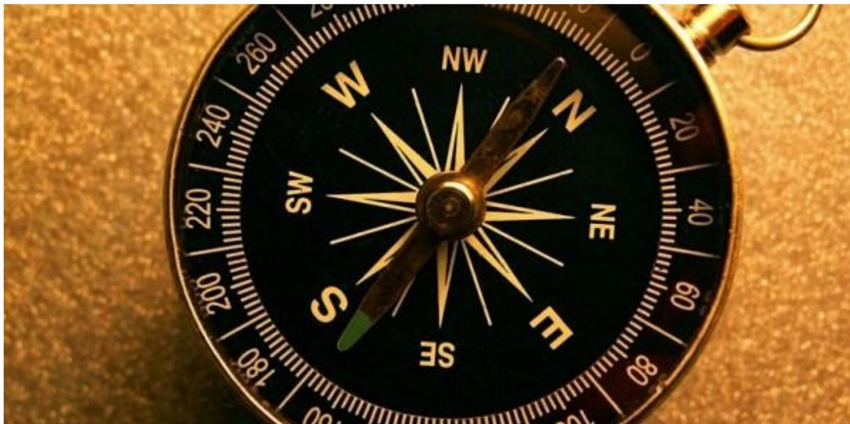
*Прибор для определения горизонтальных направлений на местности.*
