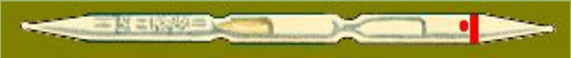
**Определение ОВ (нервно - паралитического действия – зорин, заман, Ви-Икс) в воздухе.**
