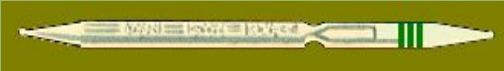
Определение ОВ (общеядовитого действия – синильная кислота, хлорциан; удушающего действия – фосген, дифосген) в воздухе
