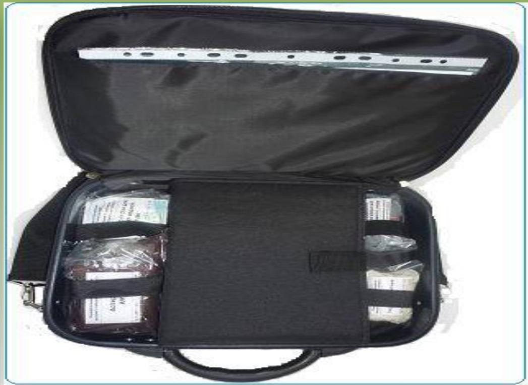
**Универсальная портативная экспресс-лаборатория «ЭЛИОС-01»** предназначена для исследования и экспресс-контроля загрязняющих и токсичных веществ в воздушной и водной среде при комплексном обследовании:
