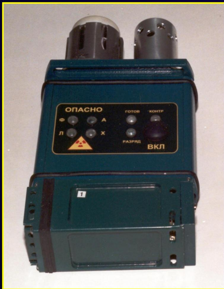
**Предназначен** для обнаружения в воздухе паров отравляющих веществ типа зарин, зоман, V-газы, люизит и сильнодействующих ядовитых веществ типа хлор, аммиак с выдачей звукового и светового сигнала оповещения.
