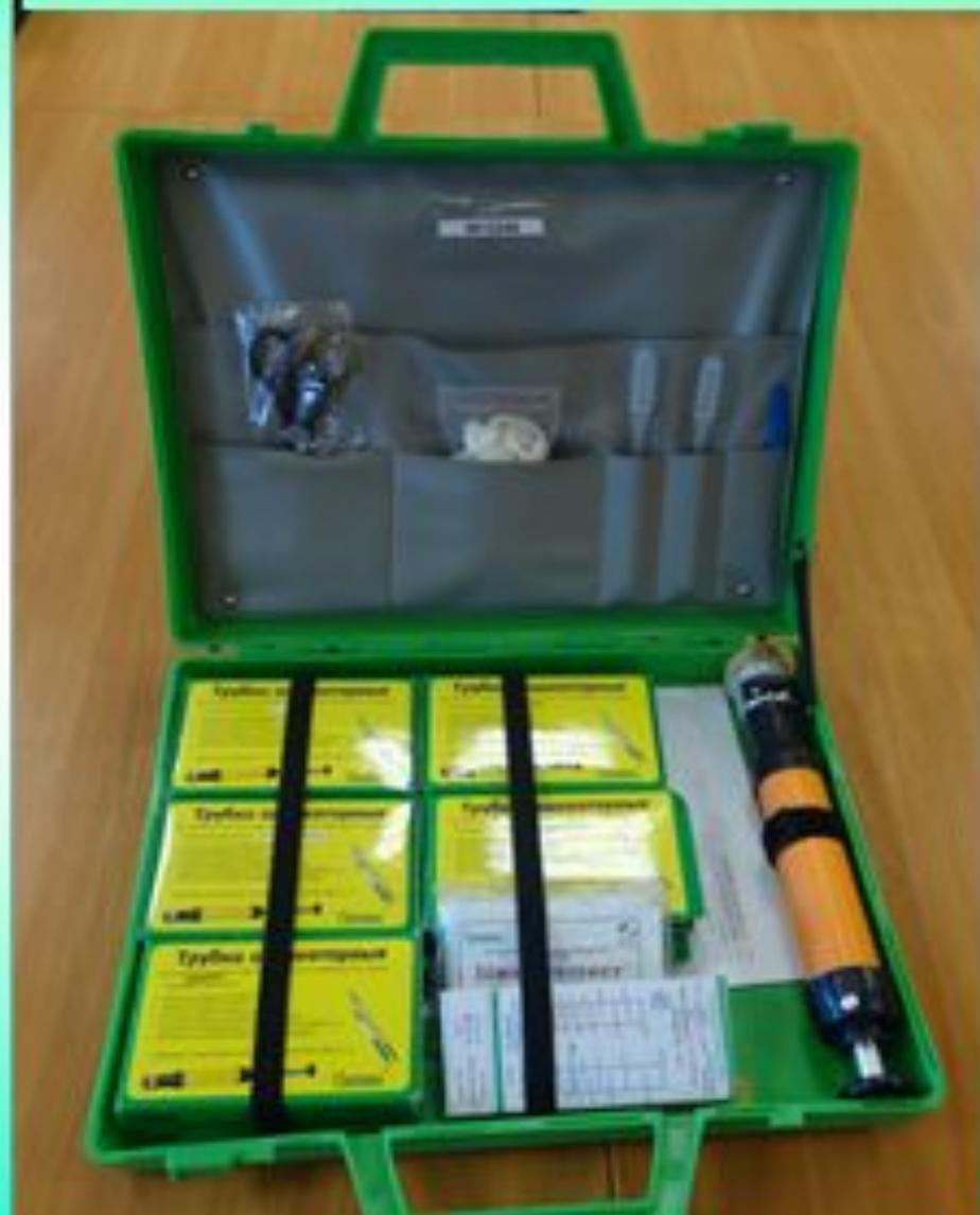
Мини-экспресс-лаборатории «Пчелка-Р» (МЭЛ) **предназначены** для измерения концентрации вредных химических веществ в воздухе с помощью индикаторных трубок, а так же наличия вредных веществ в различных средах (вода, поверхность земли, технике и т. д.) с помощью индикаторных элементов.
