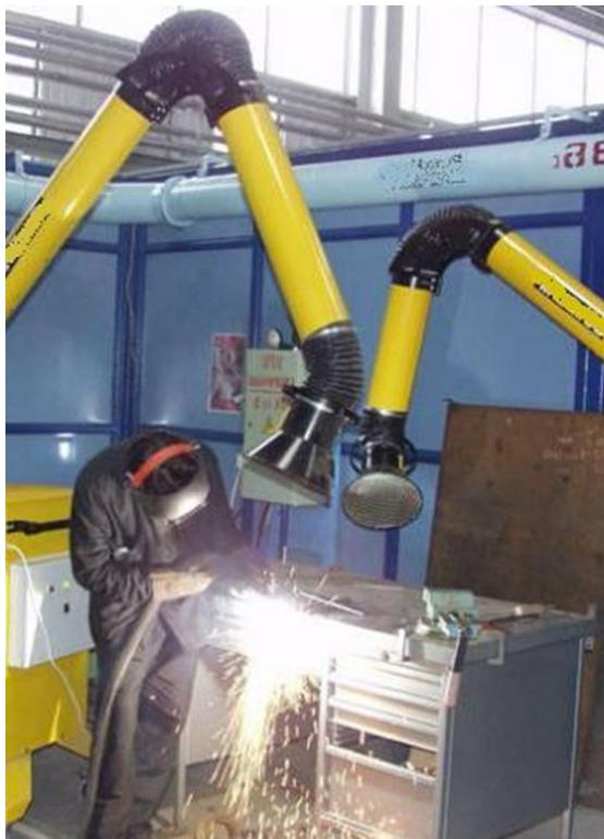
Наиболее характерным вредным фактором практически для всех способов дуговой сварки является образование и поступление в воздух рабочей зоны сварочных аэрозолей, содержащих токсические вещества. Длительное воздействие на организм сварщика вредных аэрозолей может привести к возникновению таких профессиональных заболеваний, как пневмокониоз, пылевой бронхит, интоксикация металлами и газами и др.
