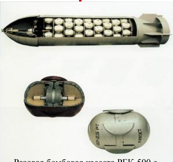
Разовая бомбовая кассета РБК-500 с авиабомбой АО-2,5 РТМ
