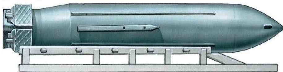
Американская «супербомба» («Мама всех бомб») GBU-43/B. Вес — 9500 кг. Вес ВВ (BSX) — 8150 кг. Бомба сбрасывается с военно-транспортного самолёта через задний грузовой люк с помощью вытяжного парашюта и специальной грузовой платформы. Попадание в цель осуществляется с помощью спутниковой системы наведения
