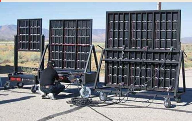
Поражение основано на использовании акустической (звуковой) волновой энергии с частотой ниже 16 Гц (чаще с 4 до 10 Гц, особо опасны – 6-8 Гц) для отрицательного воздействия на людей.
