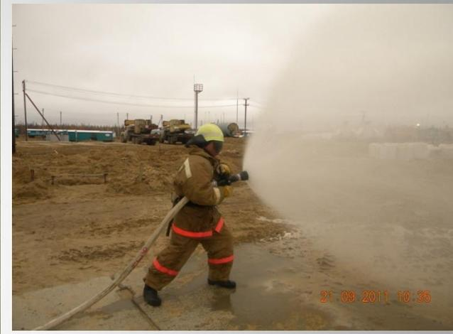
**Автоматический пожарный ручной ствол двойного давления DUAL-FORCE-RU (ДУАЛ-ФОРС) предназначен для получения сплошных и распыленных струй воды.**
