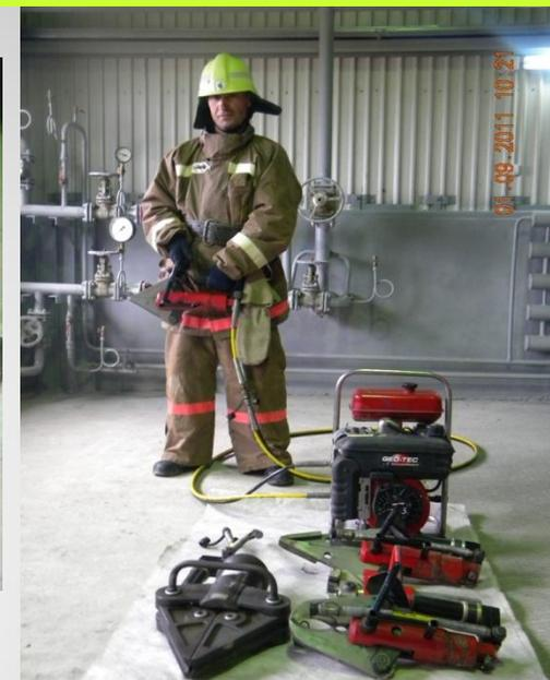
**Гидростанция «Эконт-101» (однопостовая)** Предназначена для подачи рабочей жидкости через рукава РВД6-80 в гидравлические системы механизмов аварийно-спасательного инструмента с высокими силовыми характеристиками. Привод ДВС 4-х тактный «Тесумseh», мощностью 6,5 л.с.
