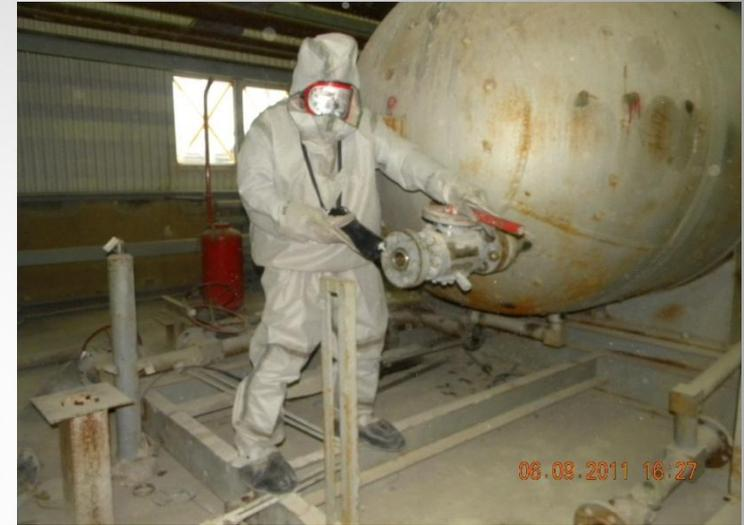
**Л-1 - предназначены для защиты кожного покрова и обмундирования при действиях в атмосфере, зараженной отравляющими или аварийными химически опасными веществами (АХОВ). Л-1 состоит из куртки с капюшоном, брюк с чулками и защитных перчаток, при проведении аварийно-спасательных работ в атмосфере высококонцентрированного газообразного хлора и аммиака (до 60 мин.), а также жидкого аммиака (2 мин.).**
