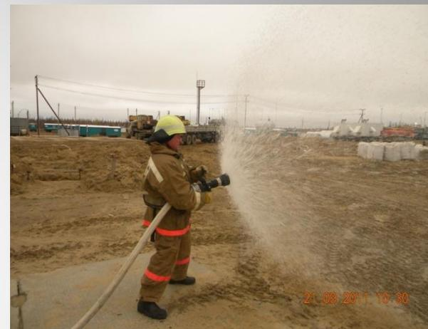
**Автоматический пожарный ручной ствол двойного давления DUAL-FORCE-RU (ДУАЛ-ФОРС) предназначен для получения сплошных и распыленных струй воды.**
