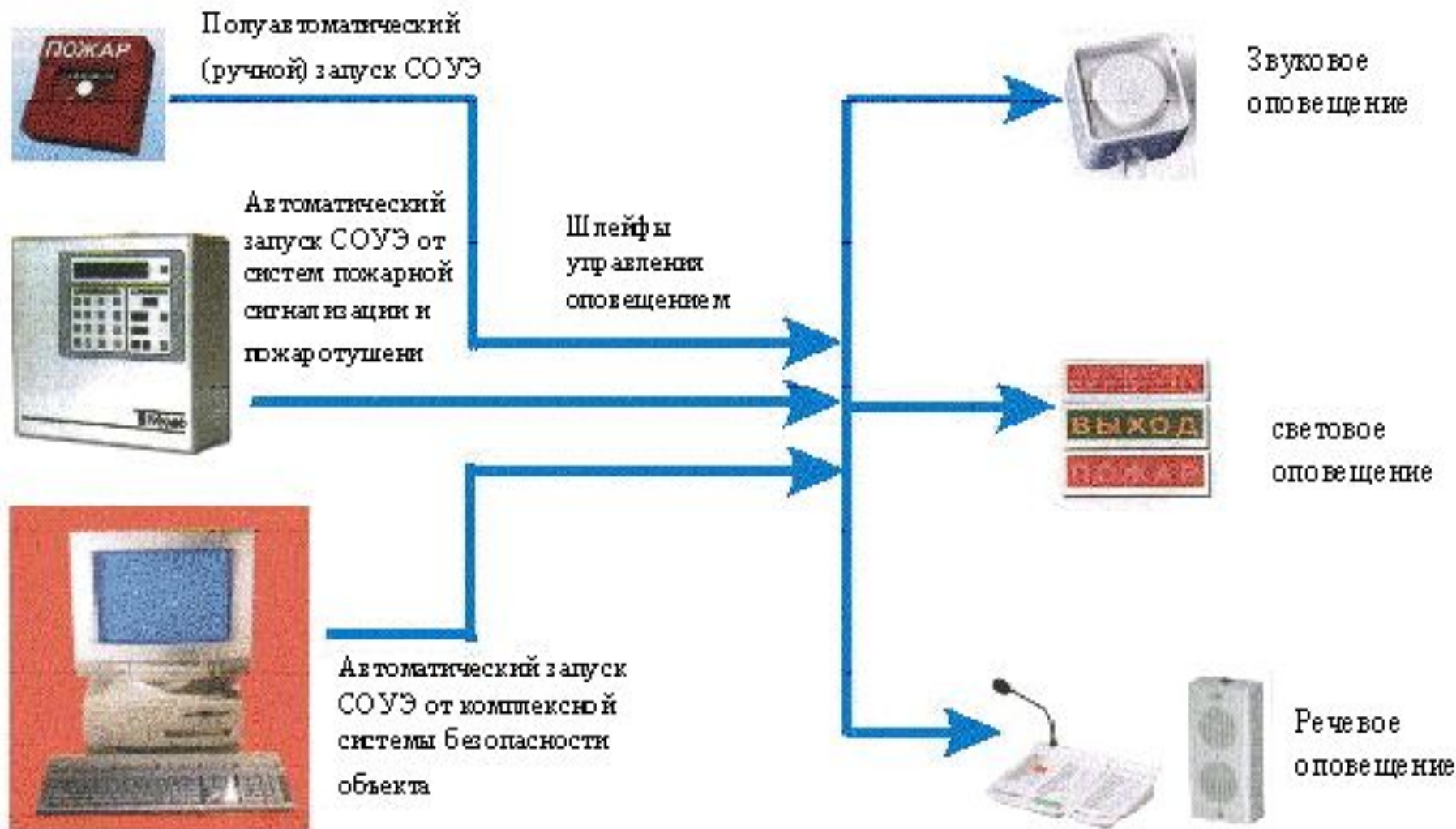
Структурная схема системы оповещения о пожаре и управления эвакуацией
