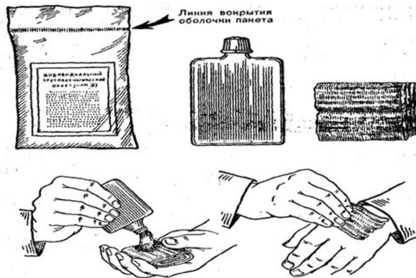
Рис. 13 Индивидуальный противохимический пакет.(ИПП-8)
