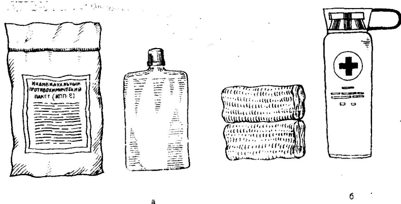
Рис. 44. Пакет индивидуальный противохимический: а — ИПП-8; б — ИПП-10
