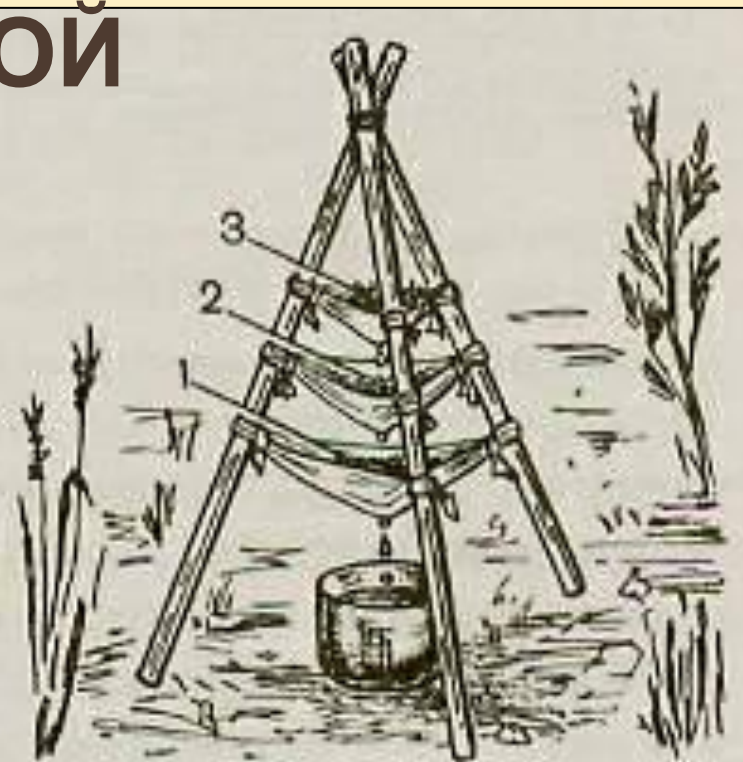
Рис. 15. Фильтрация воды: 1 — древесный уголь; 2 — песок; 3 — трава
