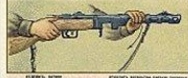
СНЯТЬ МЕХАНИЗМ ОТПИРАНИЯ ЗАТВОРА
