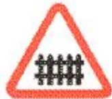
1.1 Железнодорожный переезд со шлагбаумом
