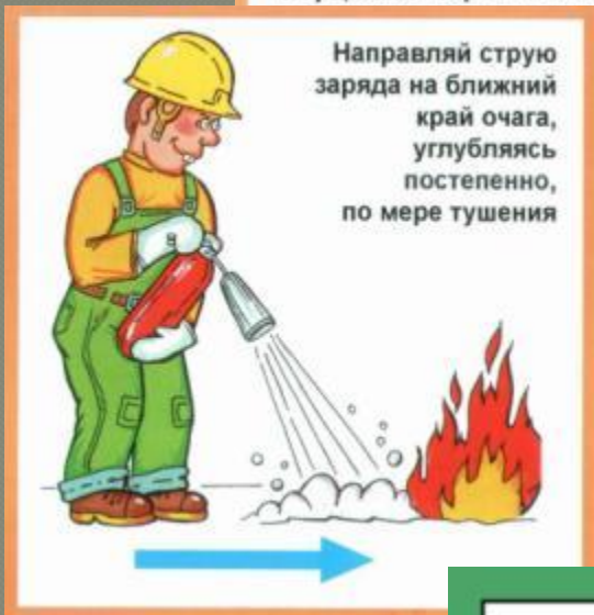
При тушении электроустановок порошковым огнетушителем подавай заряд порциями через 3-5 секунд
