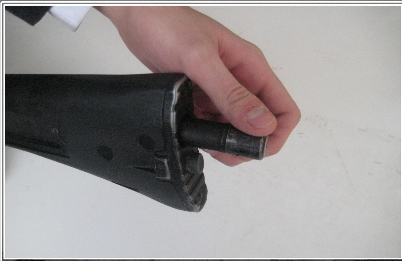
**Отделить шомпол.** Оттянуть конец шомпола от ствола так, чтобы его головка вышла из-под упора на основании мушки, и вынуть шомпол вверх. При отделении шомпола разрешается пользоваться выколоткой.
