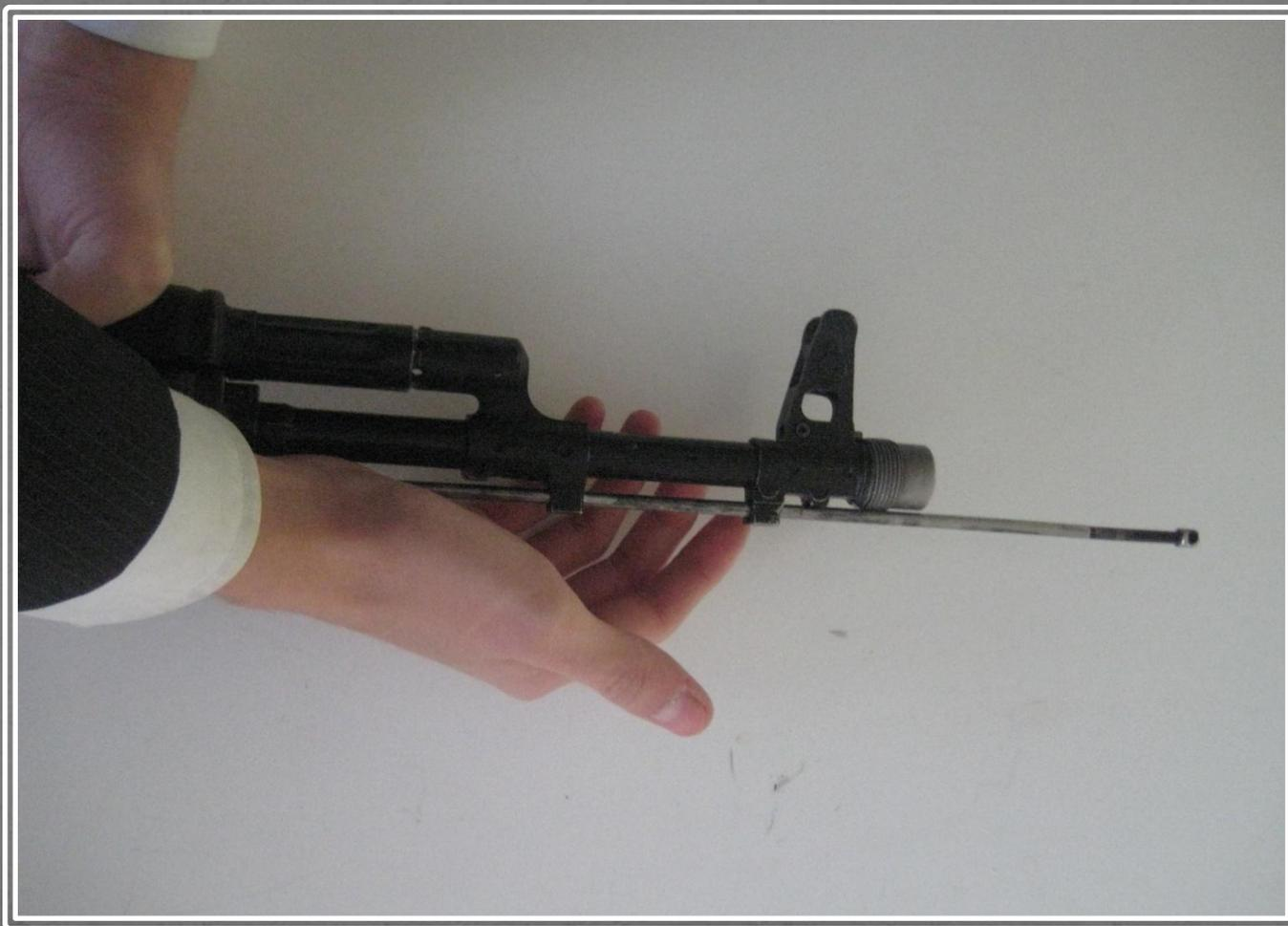
**Отделить у автомата дульный тормоз-компенсатор.** Утопить отверткой фиксатор дульного тормоза-компенсатора. Свернуть дульный тормоз-компенсатор с резьбового выступа основания мушки (со ствола), вращая его против хода часовой стрелки.
