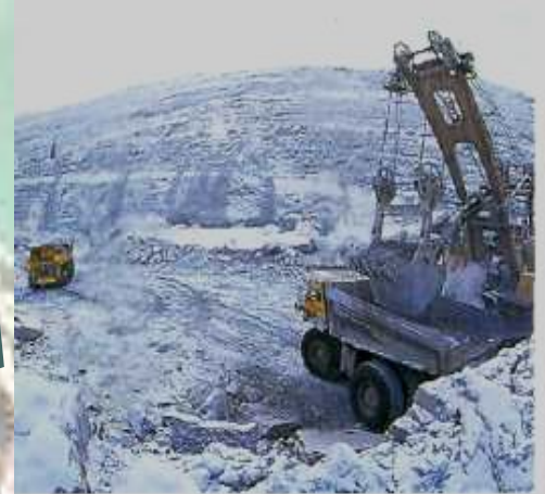
Мощные экскаваторы загружают алмазоносную породу в самосвалы грузоподъемностью 120–136 тонн.
