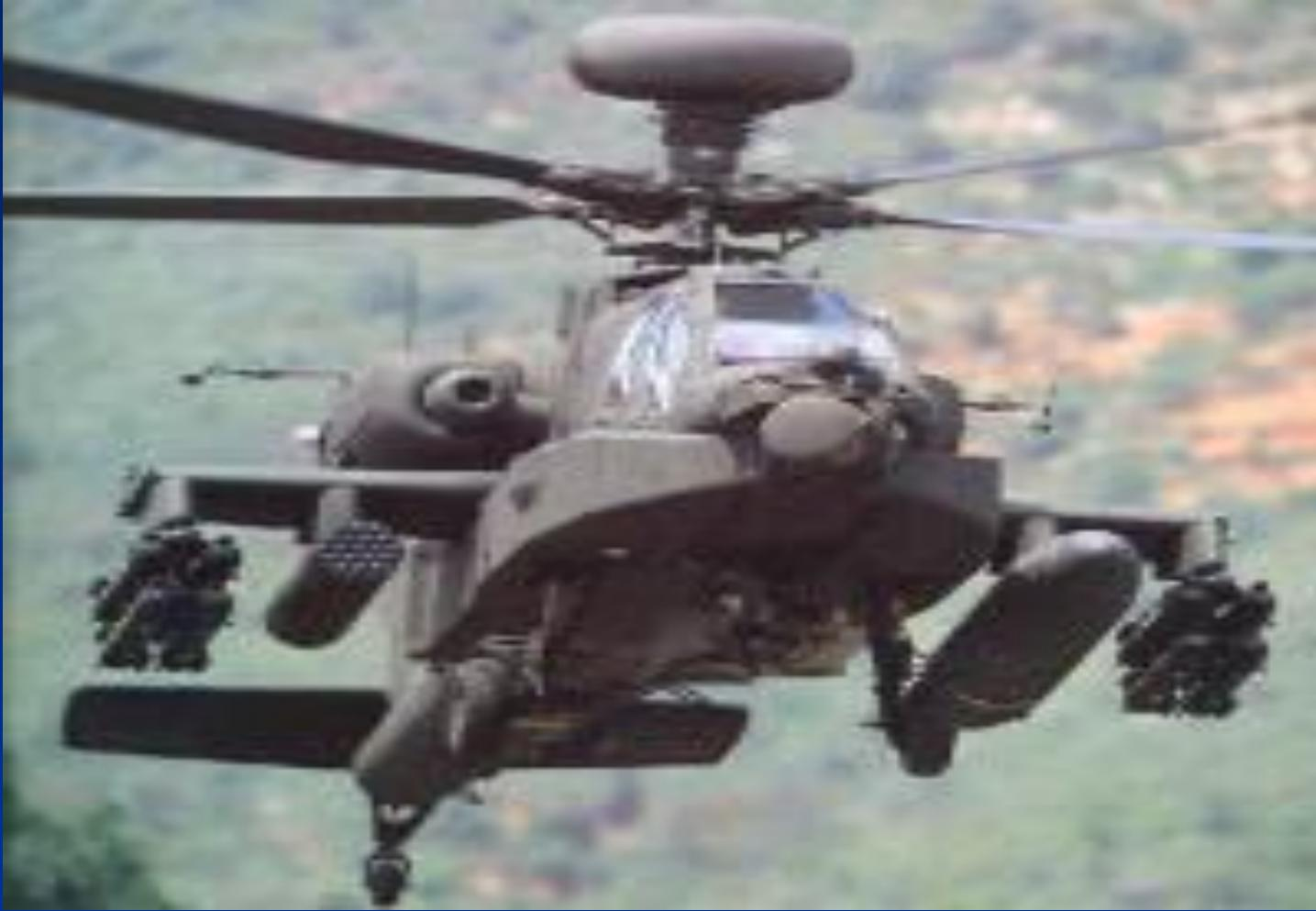
«Апач Лонгбоу» оснащен современными средствами связи и передачи данных, а так же прицельно-навигационной системой, способен в автоматическом режиме обнаружить, классифицировать, расположить по приоритетам неподвижные и движущиеся цели, а затем поразить их с безопасного расстояния практически в любых погодных условиях.
