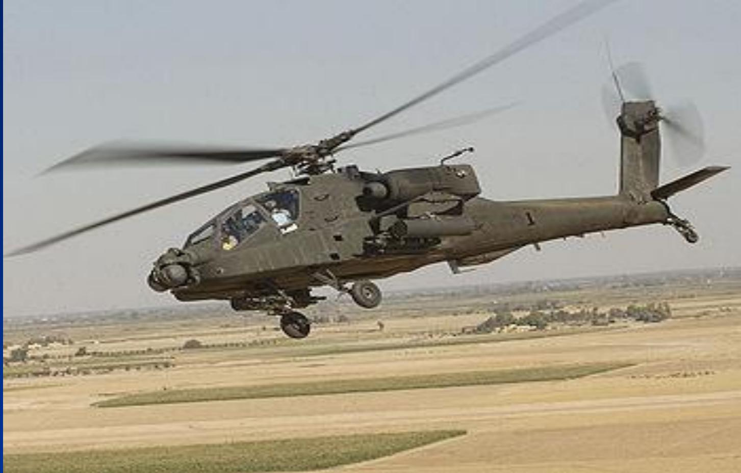
Американские конструкторы боевых вертолетов прикрывают броней лишь экипаж, считается, что спасение винтокрылой машины в бою – ее скрытность и маневренность.
