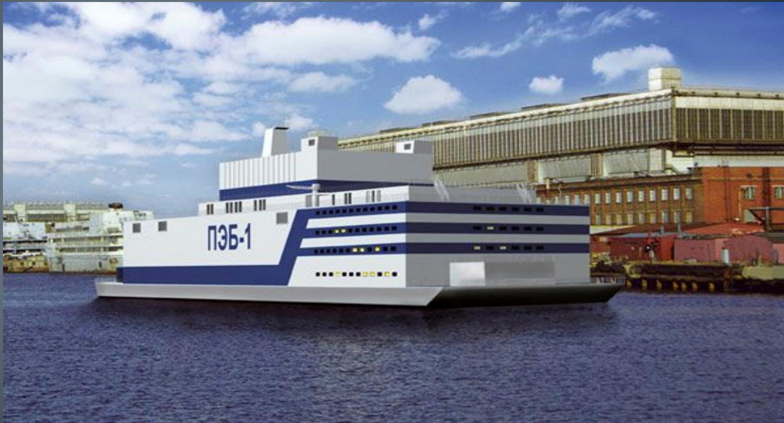
Плавучая станция может использоваться для получения **электрической и тепловой энергии, а также для опреснения морской воды**. В сутки она может выдать от 40 до 240 тысяч тонн пресной воды.
