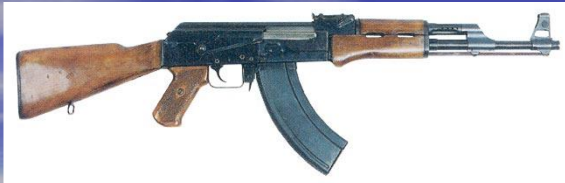
серийный автомат Калашникова АК выпуска 1949-51 годов, со штампованной ствольной коробкой
