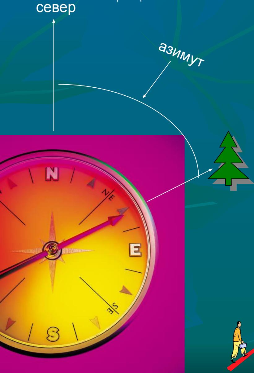
Азимут-это угол, отсчитанный на компасе по ходу часовой стрелки между направлением на север и на ориентир. Азимут измеряется в градусах от 0 до 360 гр.
