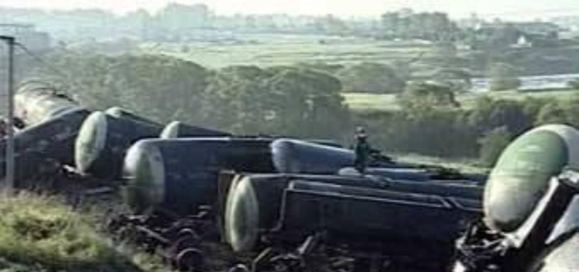
*В июне 2005 г. на перегоне Зубцов - Аристово произошел сход с рельсов 26 вагонов (цистерны с мазутом) грузового поезда N 2909. Крушение поезда произошло при скорости 70 км/ч. Поезд состоял из 69 вагонов, общий вес состава - 5106 тонн. В результате аварии произошел разрыв цистерны с разливом мазута в реку Вазуза. Все цистерны с мазутом подняты и на сегодняшний день вода в реке Вазуза не превышает допустимых значений по содержанию нефтепродуктов.*
