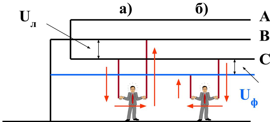
Ток  $I_{ч}$ , проходящий через человека, и напряжение прикосновения  $U_{пр}$  (В) при сопротивлении человека  $R_{ч}$  (Ом):
