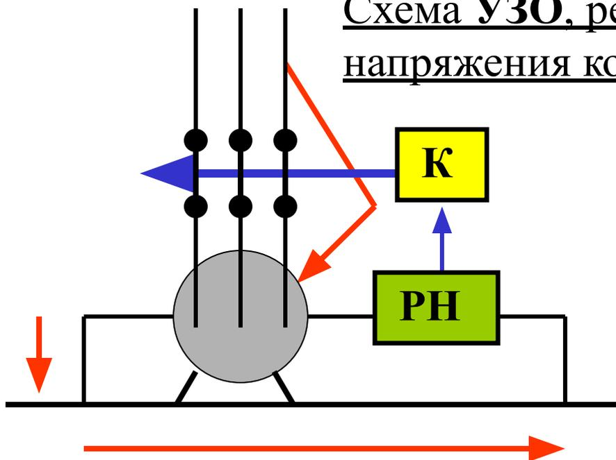
При пробое фазы на корпус срабатывает реле напряжения (РН), настроенное на определённую уставку, и установка отключается контактором (К).
