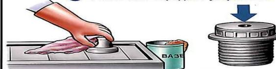
② Очистите батарею и клеммы от электролита и протрите их насухо. Клеммы смажьте техническим вазелином
