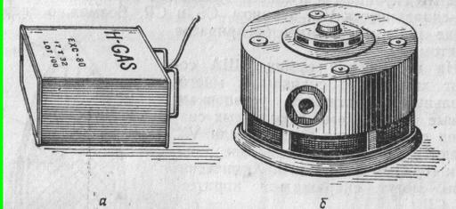
Рис. 5. Химические фугасы: а — фугас М1; б — фугас АВС-М2
