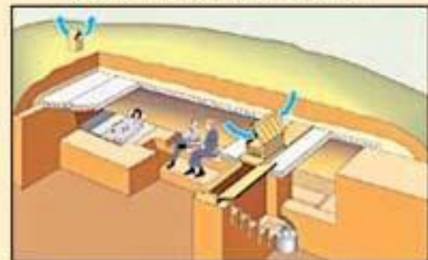
Быстровозводимое противорадиационное укрытие из железобетонных плит
