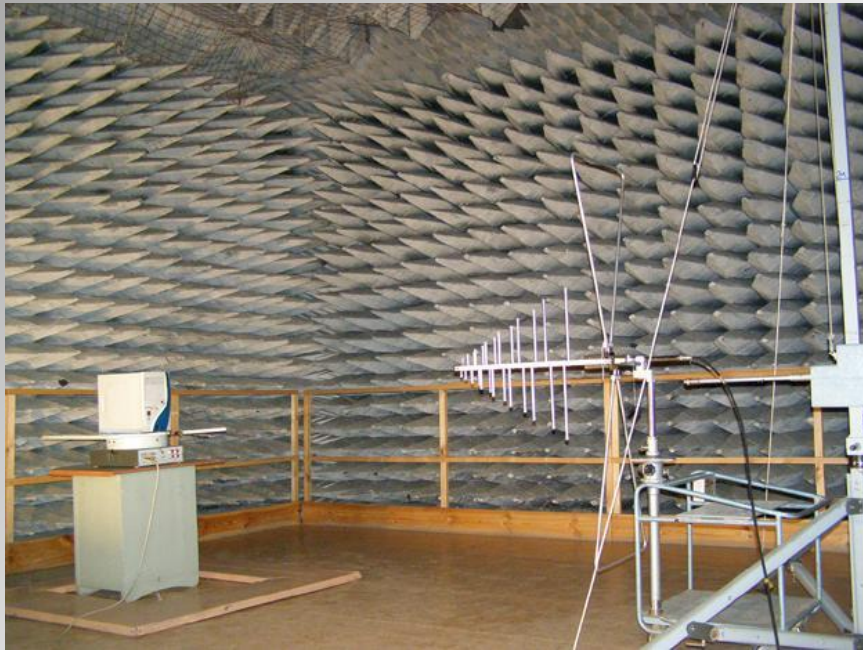
Безэховая электромагнитная камера (9x9x6 м)
