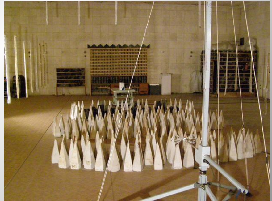
Радиоэкранированный зал (24x24x6 м)
