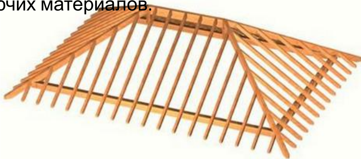
Пример кровли с висячими стропилами
