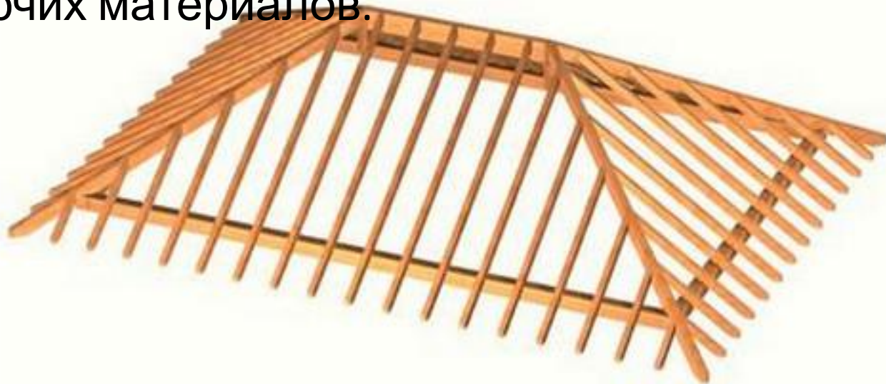
Пример кровли с висячими стропилами
