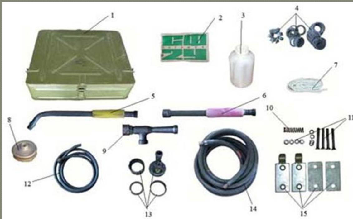
**Состав комплекта ДК-4К:** 1 – ящик; 2 – пакет с порошком СФ-2У (СФ-2); 3 – банка полиэтиленовая; 4 – запасные части; 5 – брандспойт; 6 – удлинитель; 7 – ветошь; 8 – щетка; 9 – эжектор; 10 – пружина; 11 – крепежные детали; 12 – рукав жидкостный; 13 – газоотборное устройство; 14 – рукав газожидкостный; 15 – крючок и планка.
