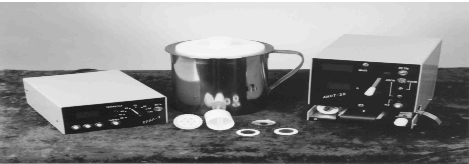
Кордон-2 трековый дозиметр
