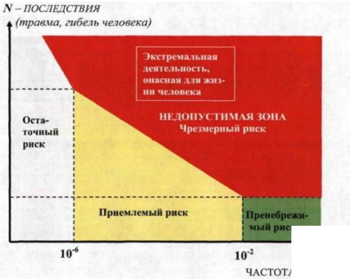
Рис. 1. «Кривая Фармера» – зависимость величины последствий от вероятности ее возникновения
