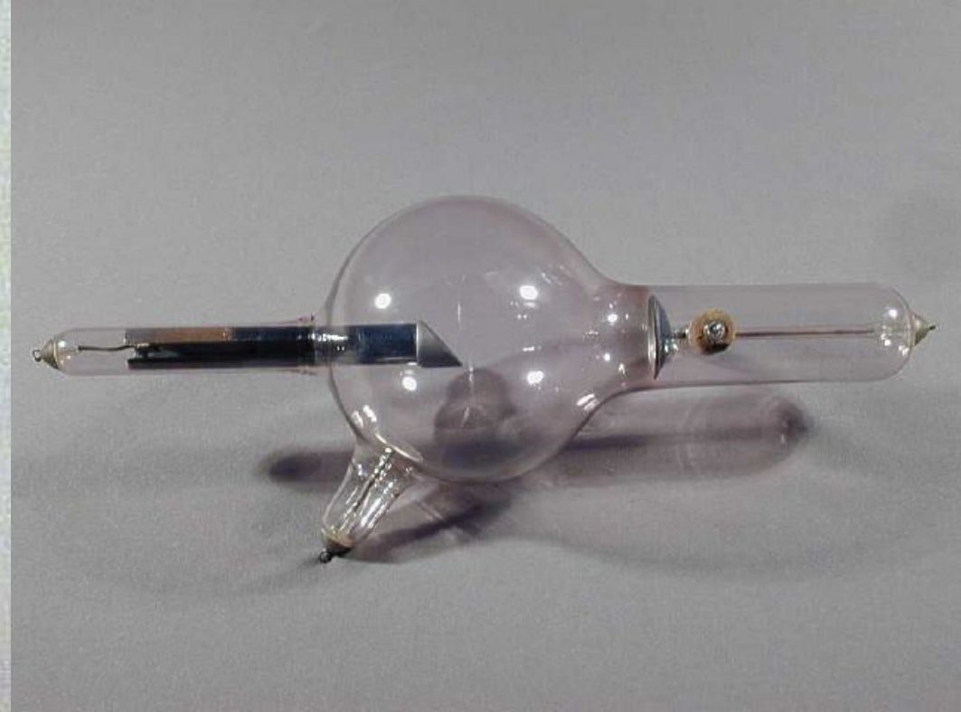
Одна из первых рентгеновских трубок
