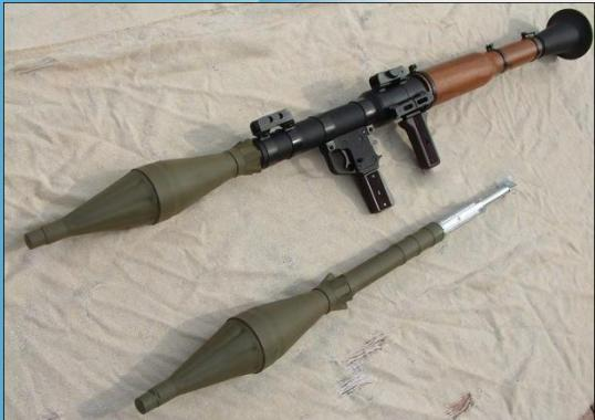
Ручной противотанковый гранатомет РПГ-7В предназначен для борьбы с танками, САУ и другими бронированными средствами противника. Кроме того, он может быть использован для уничтожения живой силы противника, находящейся в легких укрытиях, а также в сооружениях городского типа.
