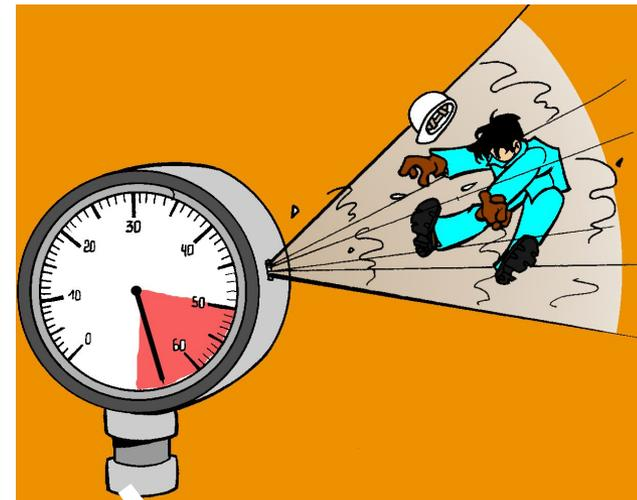
**В СЛУЧАЕ РАЗРЫВА: ЭТА ЭНЕРГИЯ ПРИВОДИТ К РЕЗКОМУ РАСШИРЕНИЮ ГАЗА.**
