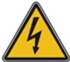
349 Опасность поражения электрическим током
