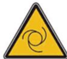
365 Внимание. Автоматическое включение (запуск) оборудования
