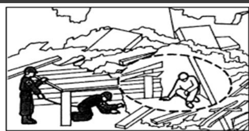
Устройство лаза в завале
