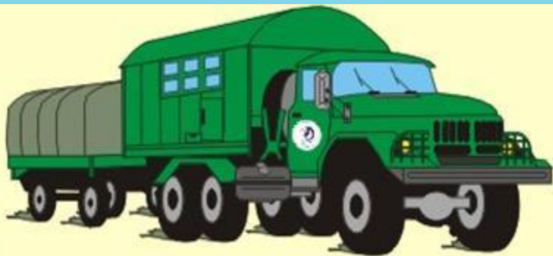
Фільтрувальна станція МАФС
