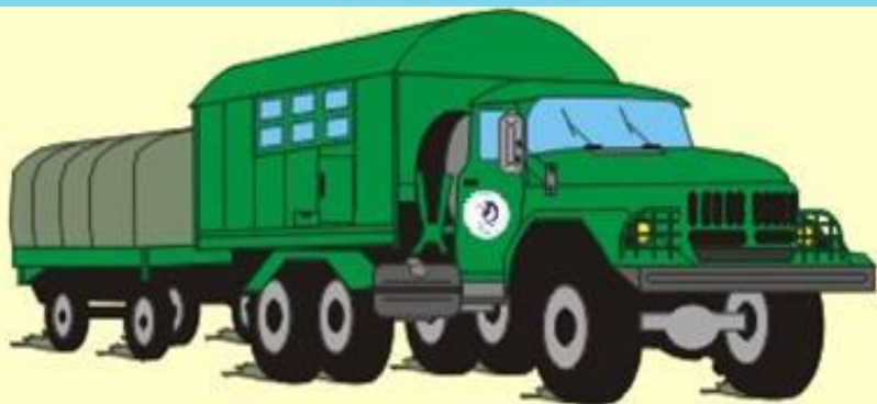
Фільтрувальна станція МАФС
