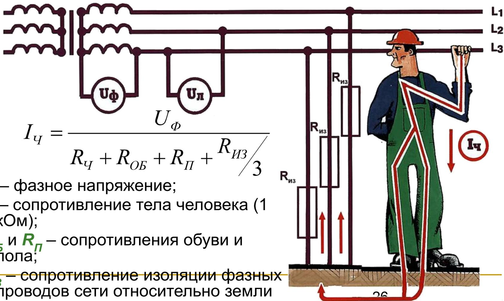
$$I_{\text{ч}} = \frac{U_{\text{ф}}}{R_{\text{ч}} + R_{\text{ОБ}} + R_{\text{П}} + \frac{R_{\text{ИЗ}}}{3}}$$
