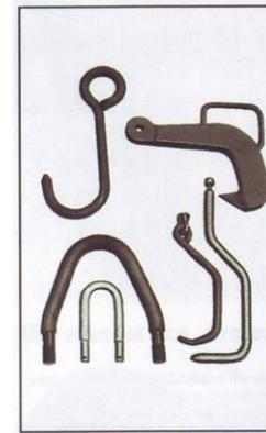
Специальные грузозахватные приспособления изготовлены в соответствии с DIN 15426. Сварка произведена аттестованными сварщиками. Сварные швы проверены на наличие трещин.
