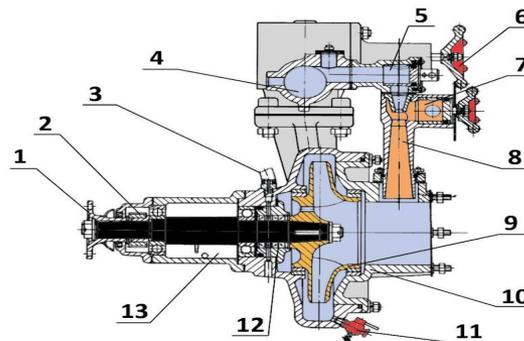
1-Фланец насоса; 2-привод тахометра; 3-шланг пресс-масленки; 4-коллектор насоса; 5-пробковый кран пенообразователя; 6-центральная задвижка; 7-дозатор пенообразователя; 8-пеносмеситель ПС-5; 9-рабочее колесо насоса; 10- корпус насоса; 11-сливной кран; 12-уплотнительный узел.
