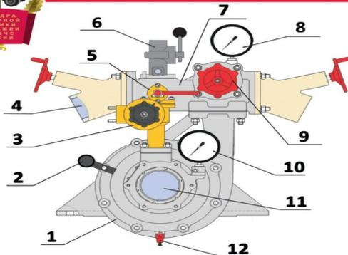
1 - корпус насоса; 2 - масленка; 3 - пеносмеситель ПС-5; 4 - напорная задвижка; 5 - пробковый кран; 6 - вакуумный затвор; 7 - коллектор насоса; 8 - манометр; 9 - центральная задвижка; 10 - мановакуумметр; 11 - всасывающая линия насоса; 12 - сливной кран.
