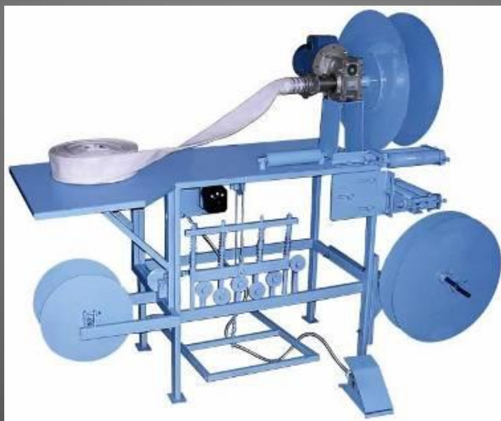
Рис.6. Станок ТЦ-15П для навязки пожарных рукавов
