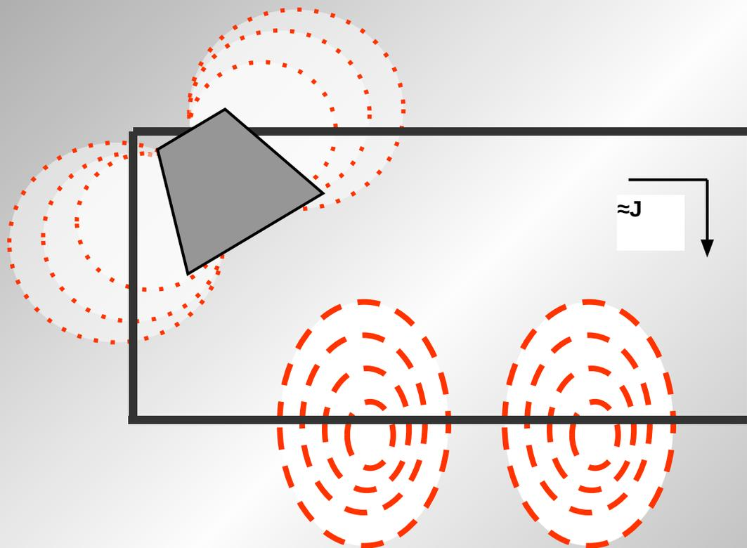
Эффект «переизлучения» магнитных полей от дисплея, расположенного на столе с металлическим замкнутым каркасом
