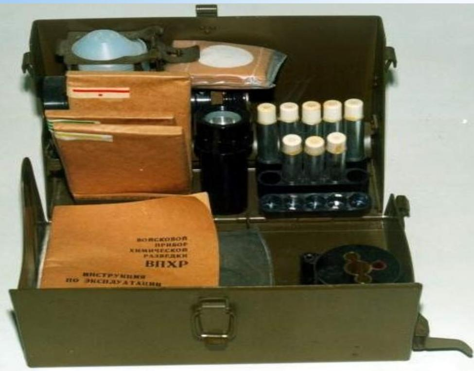
Чехлы кассет и кассеты для ИТ имеют одинаковые с трубками маркировки. На этикетках кассет содержится краткое описание работы с ИТ, цветные эталоны для сравнения с ними окраски, возникающей на наполнителе использованной трубки.
