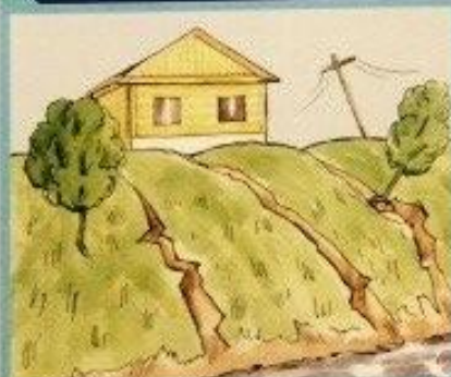
Признаки надвигающегося оползня: появление трещин и расщелин в почве, трещин в стенах домов, просачивание воды на оползнеопасных склонах
