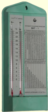
психрометр стаціонарного типу
